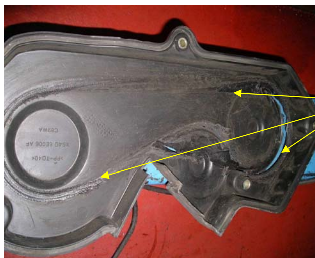
Rys. 3 Ślady ocierania na wewnętrznej stronie pokrywy na skutek kontaktu z boczną krawędzią paska rozrzędu
