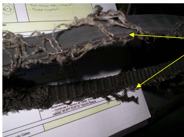
Rys. 2 Typowe oznaki wytarcia na boku paska
